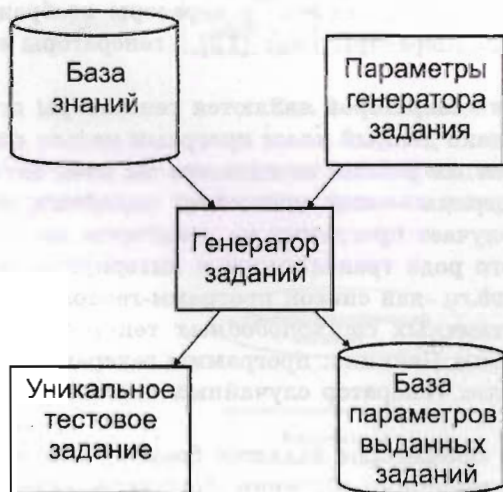
Рис. 4. Обобщенная структура генератора заданий Рис. 5. Алгоритм работы генератора заданий
