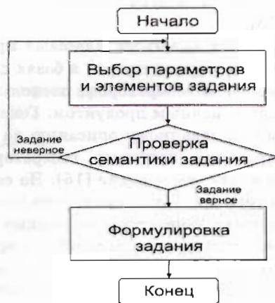
Рис. 4. Обобщенная структура генератора заданий Рис. 5. Алгоритм работы генератора заданий
